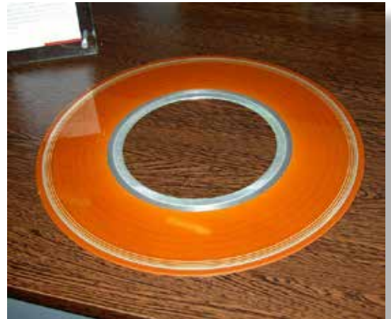
Un des plateaux d'un RAMAC 350
